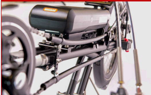
Kettenführung in Ummantelung aus Teflonrohr
